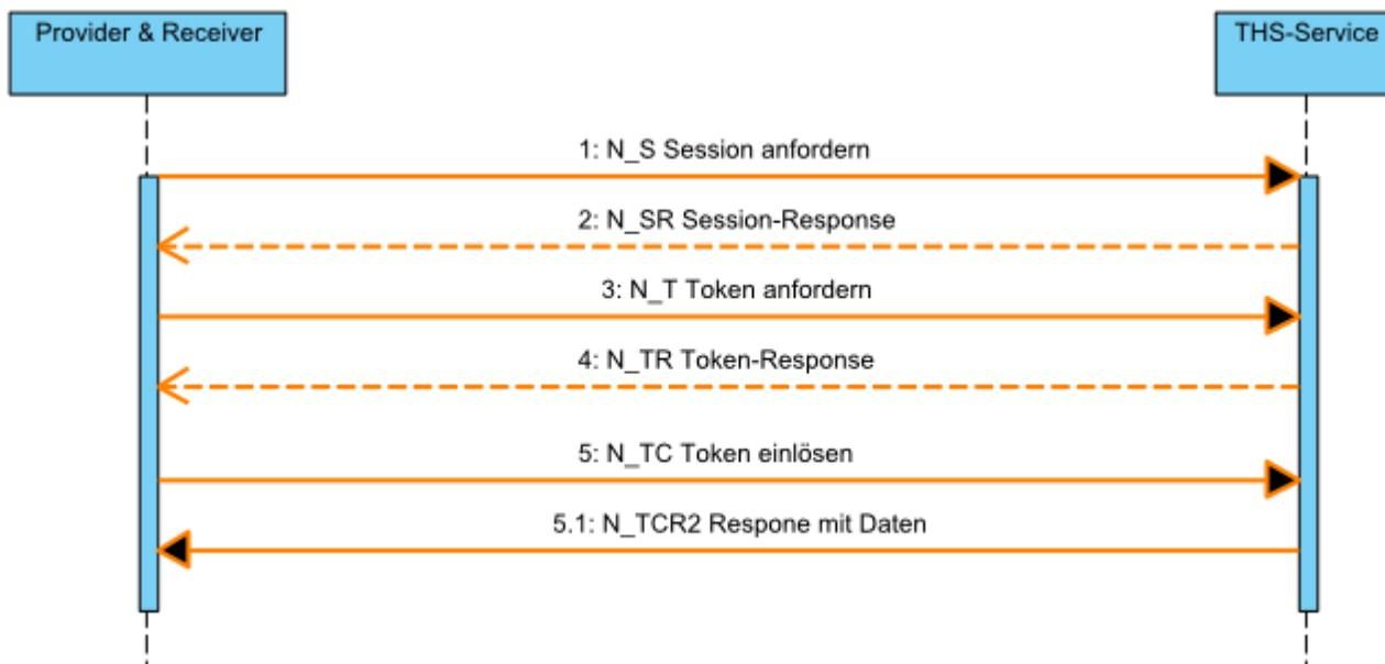
Folgende Abbildung 4 zeigt den Ablauf in einem Sequenzdiagramm.
