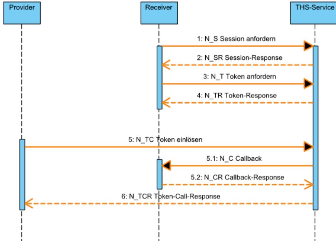
Abbildung 2 zeigt den Ablauf in einem Sequenzdiagramm und folgende Tabelle beschreibt die Nachrichten der primären Kommunikation im Detail.
